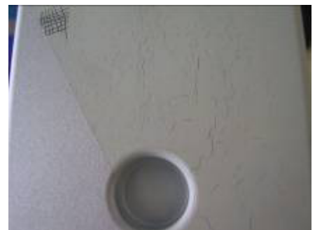
Lösemittelangriff einer 2K-Epoxygr. lsm. auf einem ABS-Bauteil!
