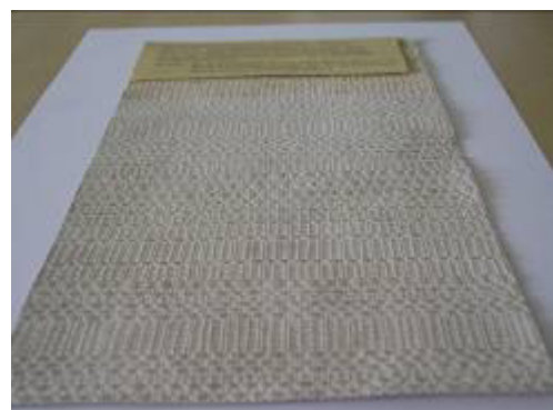
Seidenglanz-Dispersion auf Vinyltapete mit Weichmacher → führte zu klebriger Oberfläche und Verschmutzung!
