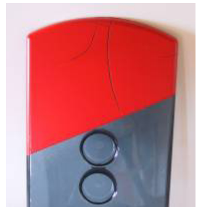
Lösemittelangriff von ATAPUR 2000 auf einem Makrolon-Bauteil!
