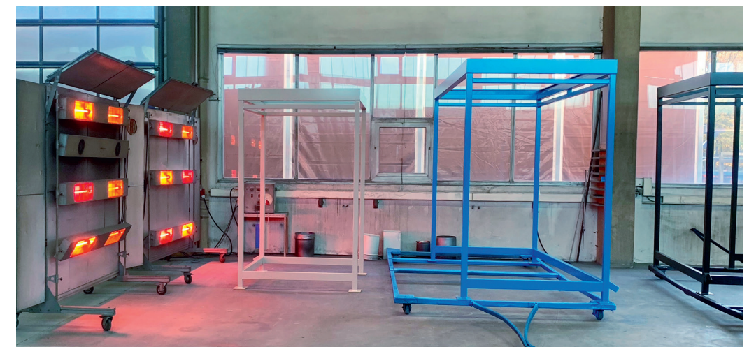
Die Trocknung wird unterstützt durch IR-Strahler. Entscheidender Mehrwert von RUCOPUR HS 2in1: Grosse und «unhandliche» Objekte müssen durch das Einschichtverfahren viel weniger manövriert werden. Dies spart Zeit, Platz und schlussendlich Geld.
